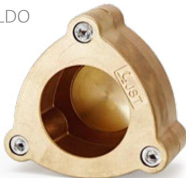
La muffola JST è stata sviluppata in collaborazione con il maestro odontotecnico Jürg Stuck. Tre viti ad esagono interno tengono unite le due metà della muffola e rendono superflua la scomoda staffa. Le guide coniche in acciaio centrano le parti inferiore e superiore e le uniscono perfettamente senza lasciare fessure. Nell'impiego degli AESTHETIC Intensive Colors (zeppatura della gengiva a più colori) si possono evitare errori di pressatura, grazie alla possibilità della chiusura asimmetrica.
